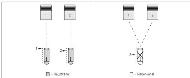
Abb. 3 Nebenkanaäle in Empfänger 1 und 2 sollen gelöscht werden.
